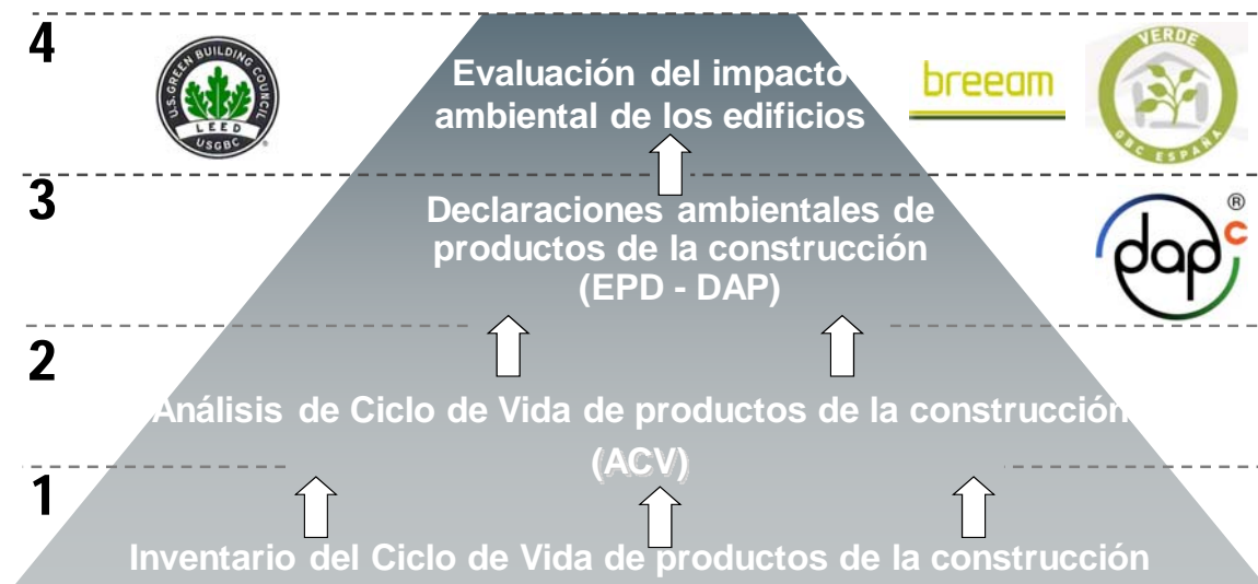
Pirámide de procesos establecida en la 3.ª Conferencia de ministros europeos de vivienda de 2002 en Genvál (Bélgica)
